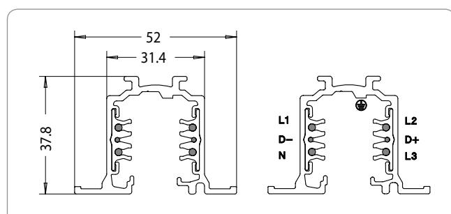
**ADAPTADOR SIMÉTRICO COM 6 CONDUTORES
