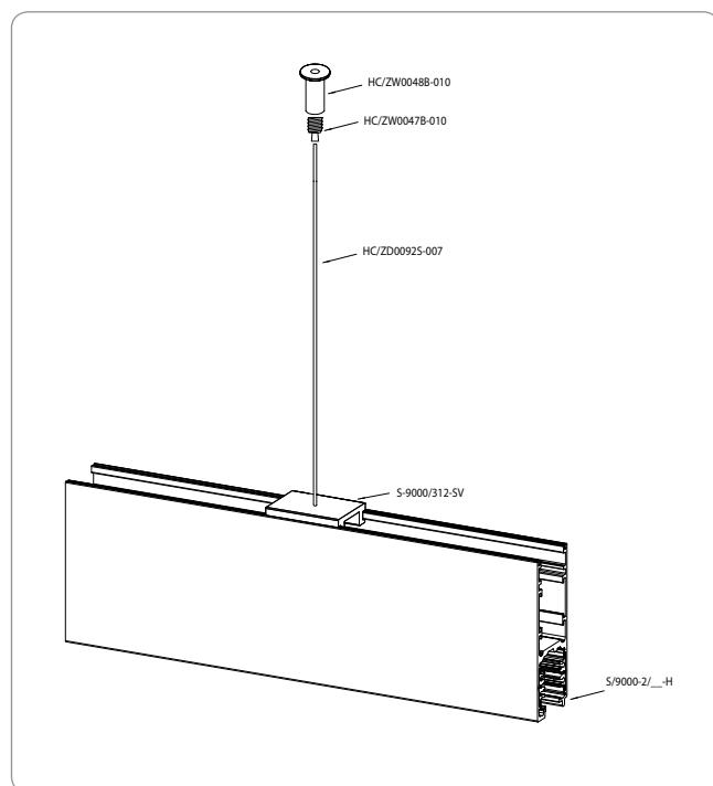
Sistema de suspensão através de haste rígida rosqueada em fixador de teto modelo S/9000/P3. A haste deverá ser rosqueada no suporte curto para suspensão rosca 1/4 modelo S/9000/112-1/4 e fixada no trilho eletrificado trifásico.
