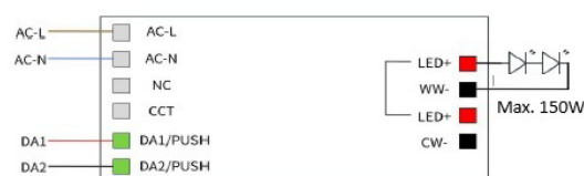
Saída WW conectada a uma luminária de cor única.
